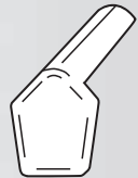
19 Firstabschluss für Wellfirsthaube zweiteilig Escudo para caballote articulado dos piezas
